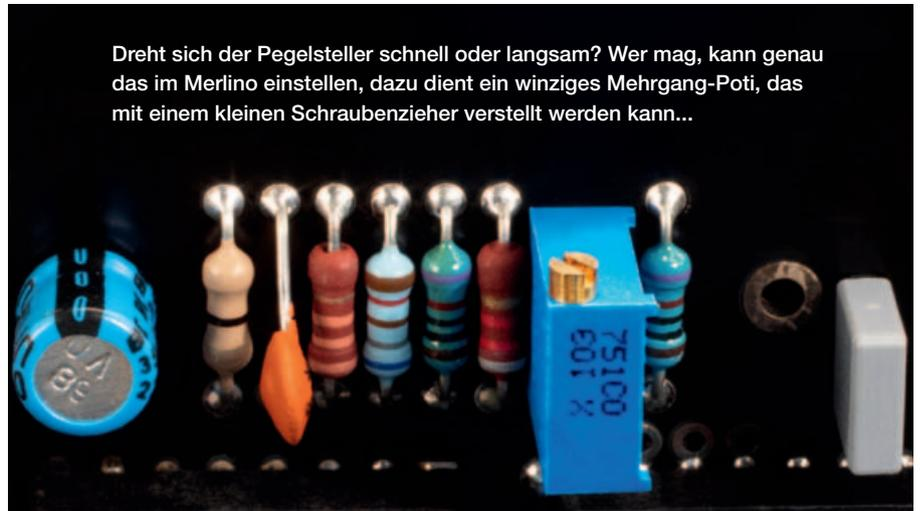
serven sowie die praxisgerecht niedrige Ausgangsimpedanz lassen uns aber mutig spekulieren, dass wir es beim ersten Triodensystem mit einem Anodenfolger zu tun haben, der das als Kathodenfolger geschaltete zweite Triodensystem der E88CC speist. Detail am Rande: Ein auf der Fernbedienungsplatine angeordnetes Poti erlaubt es, die Stellgeschwindigkeit des Motor-Pegelstellers von Alps zu beeinflussen, so etwas sehen wir zum ersten Mal...
