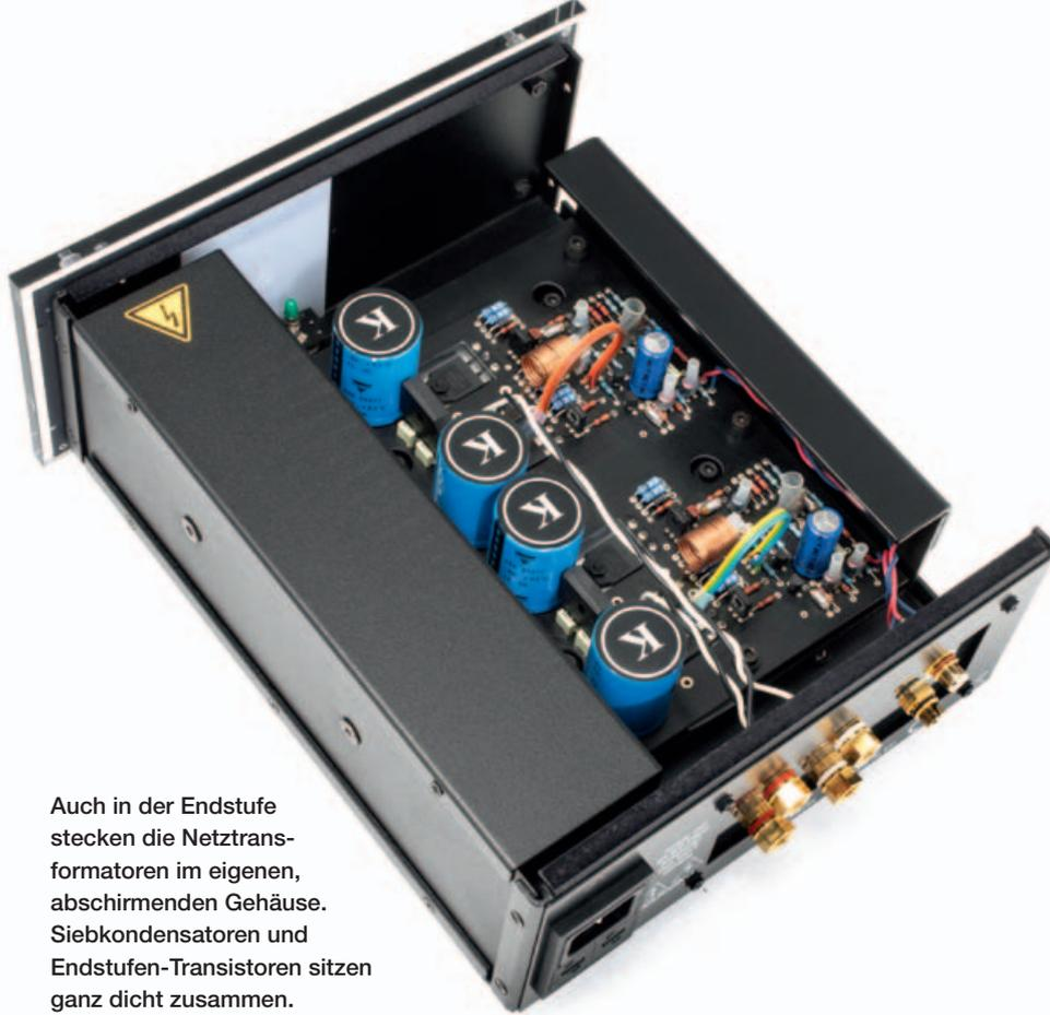
Auch in der Endstufe stecken die Netztransformatoren im eigenen, abschirmenden Gehäuse. Siebkondensatoren und Endstufen-Transistoren sitzen ganz dicht zusammen.
