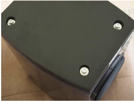
Bild 6: Die Standfläche der Box mit den Befestigungsschrauben für die Abstands-Säulen
