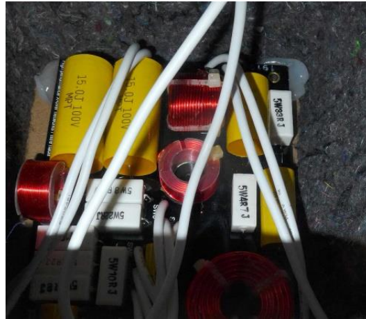
Bilder 3 und 4: Ein Blick ins Innere gibt die Ansicht des Downfire-Rohres und der Frequenzweichenplatine frei
