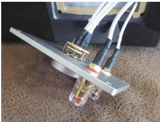
Bild 5. Klangschieber und Anschlussbuchsen sitzen auf einer 5 mm starken Alu-Platte
