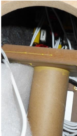
Bilder 3 und 4: Ein Blick ins Innere gibt die Ansicht des Downfire-Rohres und der Frequenzweichenplatine frei
