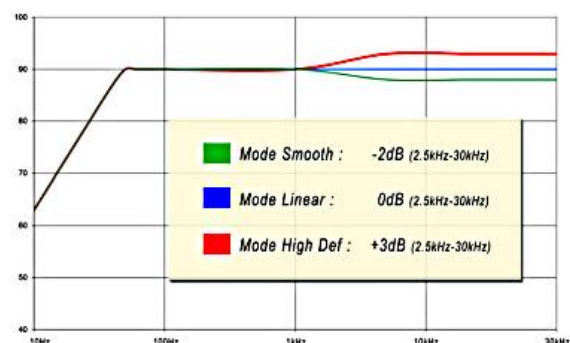
Bild 12: Der Klangschieber stellt eine sinnvolle Einrichtung zur Raumanpassung und/ oder für persönliche Soundvorlieben dar.
